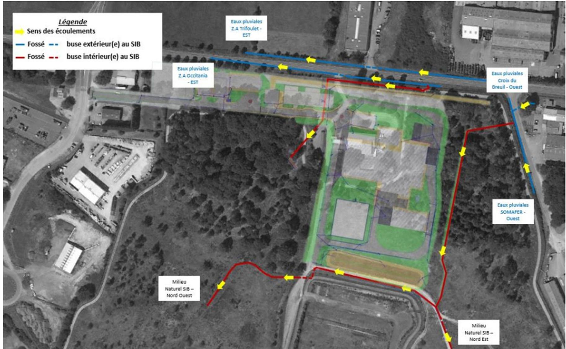
Figure 55 : Plan du réseau des eaux pluviales ATEF
