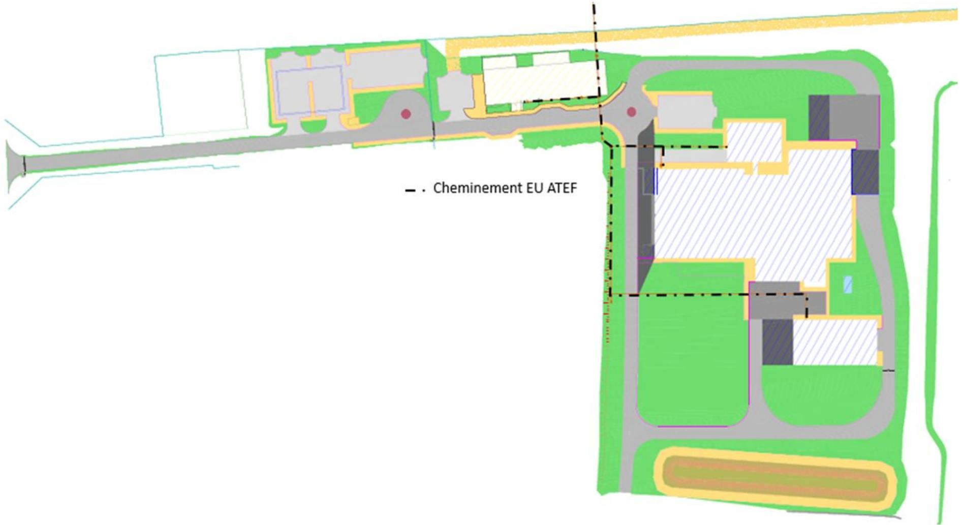
Figure 53 : Plan du réseau des eaux usées provenant de l'installation ATEF
